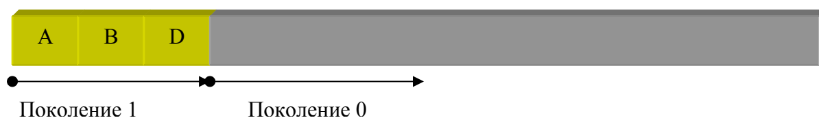
Рис. 3.2. Вид кучи после сбора мусора: выжившие объекты из поколения 0 переходят в поколение 1, поколение 0 пусто
