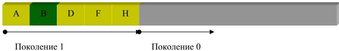
Рис. 3.4. Вид кучи после второго сбора мусора: выжившие объекты из поколения 0 переходят в поколение 1 (увеличивая его размер), поколение 0 пусто
